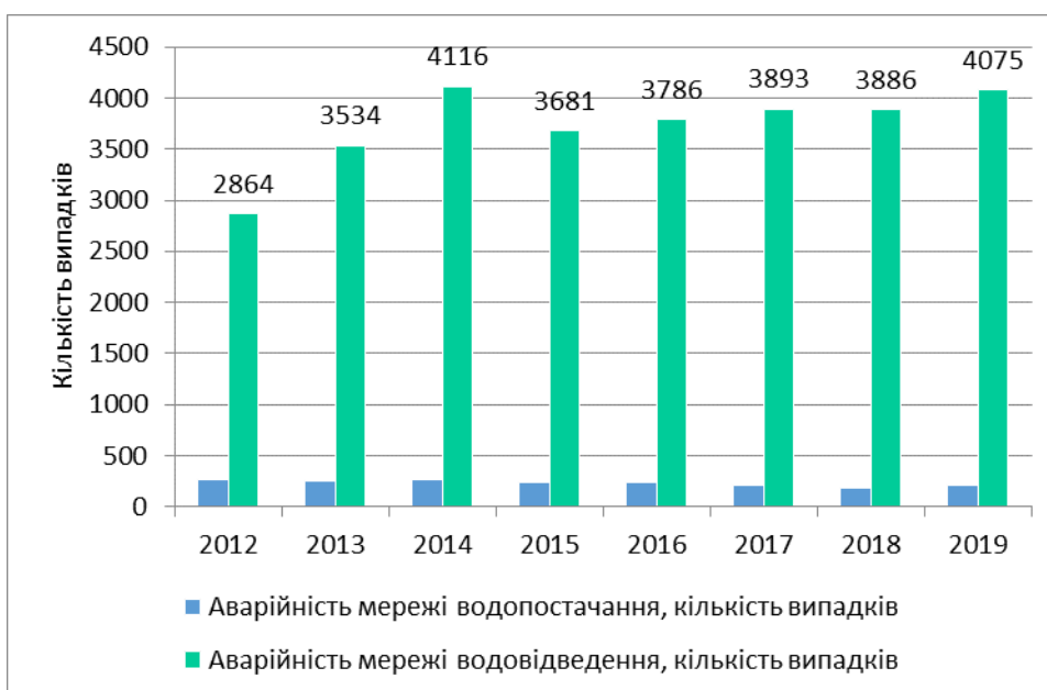
Рис. 2.10. Аварійність мереж водопостачання та водовідведення в м. Коростень
